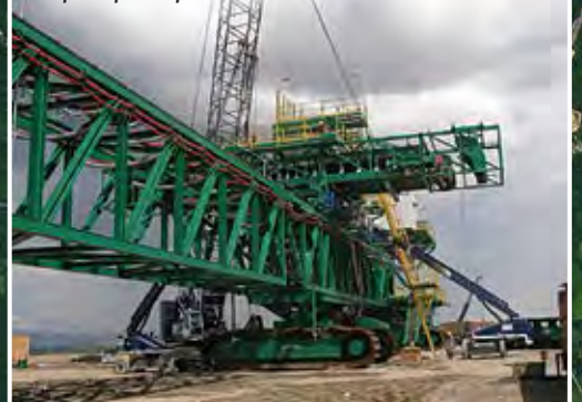
Sistem penyebaran untuk menumpuk lapisan penutup lebih rata
