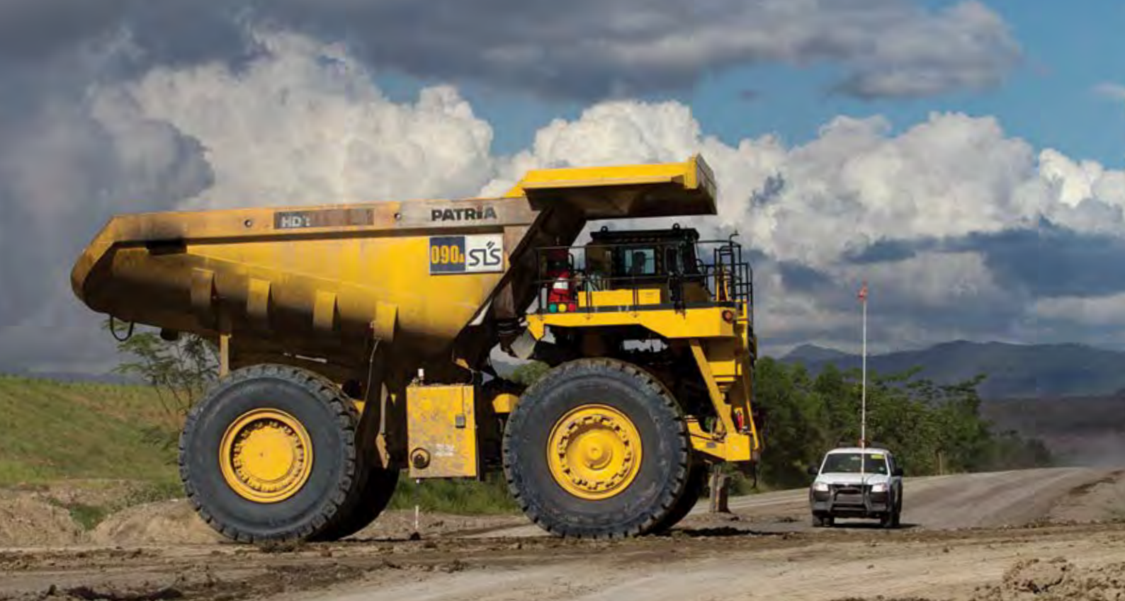
Pergerakan lalu lintas didalam area tambang dikendalikan dengan sangat ketat dan keselamatan adalah yang terpenting untuk meminimalisasi kejadian kecelakaan. Truk dumping raksasa memperoleh prioritas dan kendaraan reguler selalu dilengkapi panji-panji yang tinggi untuk membantu visibilitas pengemudi truk.
